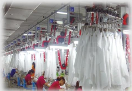
衬衣智能吊挂生产线
