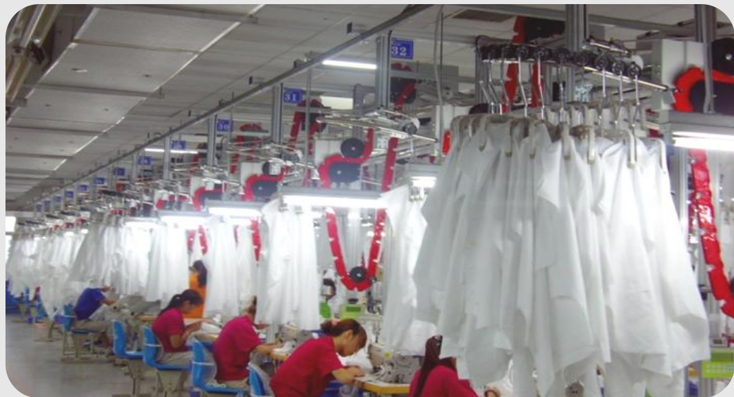
智能吊挂生产线
